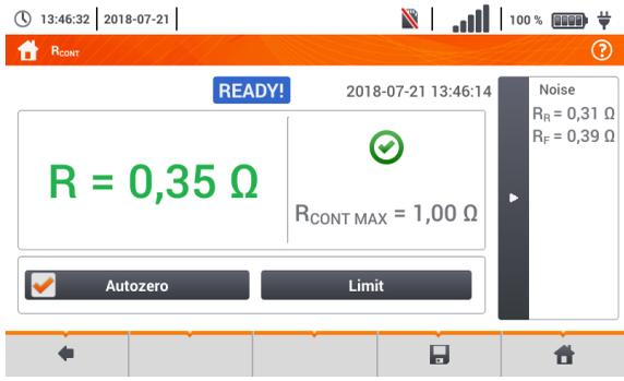
$R_F$  – Ergebnis erzielt durch **positive** Messstrom
