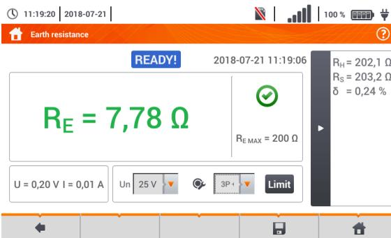
R<sub>H</sub> – Widerstand der Stromelektrode
