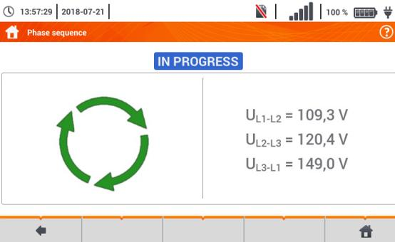
Phasensequenz **richtig**, im Uhrzeigersinn
