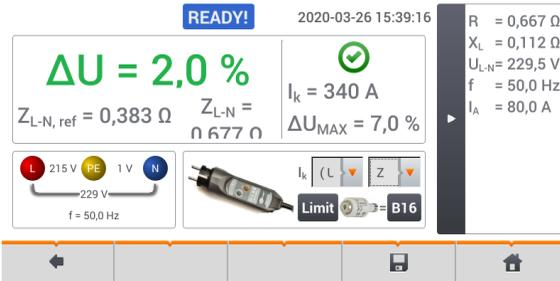
$\Delta U$  – Hauptergebnis mit der Anzeige, dass das **Kriterium**  $\Delta U_{MAX}$  erfüllt wurde:
