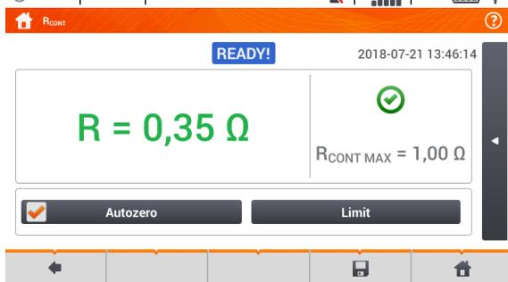
Das Ergebnis ist der arithmetische Wert aus zwei Messungen, durchgeführt mit 200 mA positiver  $R_F$  und negativer Polarität  $R_R$ .
