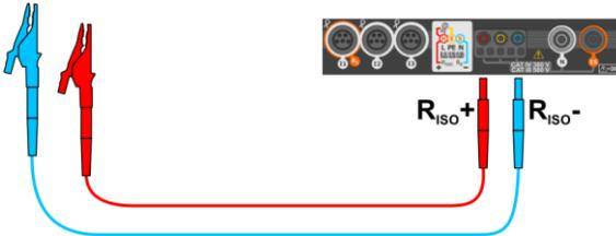
Schließen Sie die Sonden am Prüfgerät an
